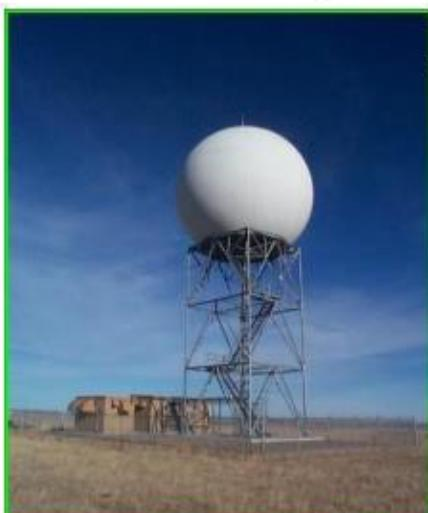
Photographie d'un radar Doppler (Etats Unis) permettant de détecter les tornades.
